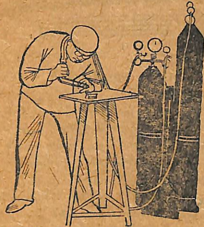
Նկ. 7 Չրածնա-թթվածնային բոցով կտրում են յերկաթե տախտակը:
